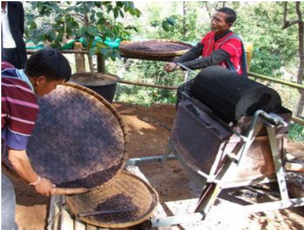
ภาพประกอบ 35 เครื่องคั่วกาแฟระดับครัวเรือน
