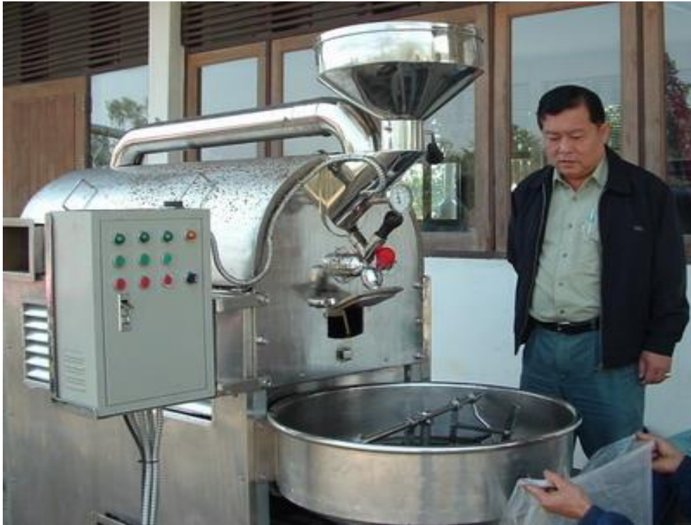
ภาพประกอบ 36 เครื่องคั่วกาแฟระดับอุตสาหกรรมขนาดเล็ก (ขนาด 10 กิโลกรัม)
