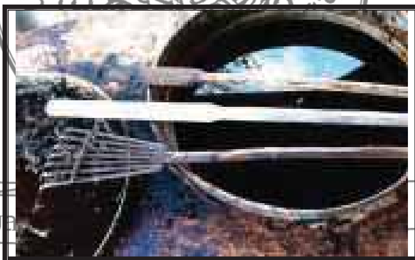
ภาพที่ 5 แสดงเครื่องมือและอุปกรณ์ในการทำกระดาษ คือ กระตะ ไม้พาย คราด
