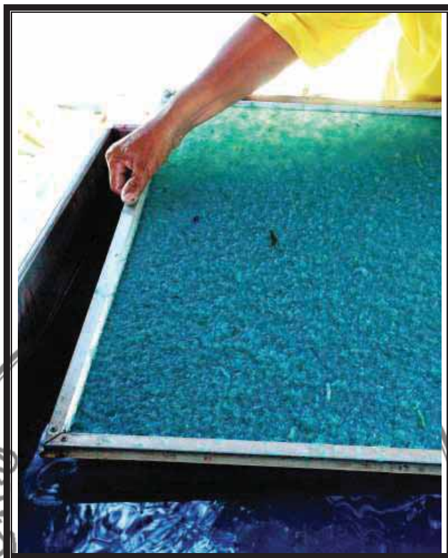
ภาพที่ 34 แสดงการช้อนเอาเยื่อกระดาษให้ติดเฟรมขึ้นมา
