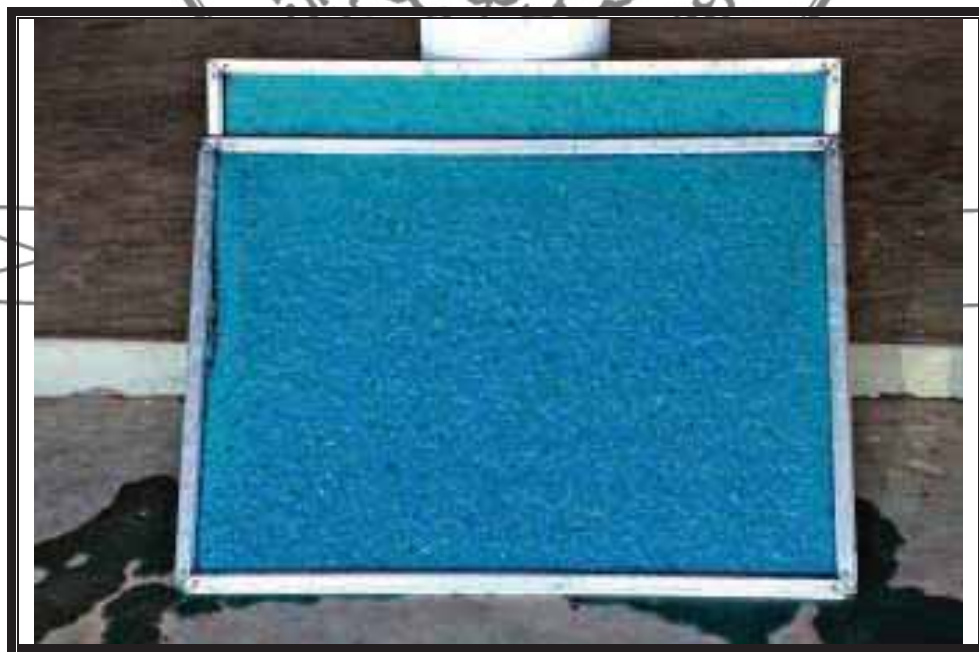
ภาพที่ 34 แสดงการช้อนเอาเยื่อกระดาษให้ติดเฟรมขึ้นมา
