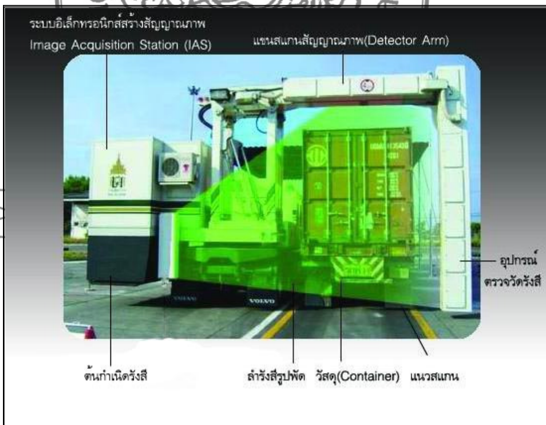
ภาพที่ 10 รูปภาพแสดงการตรวจสอบวัตถุภายในตู้สินค้าด้วยเทคนิคการส่งผ่านรังสี
