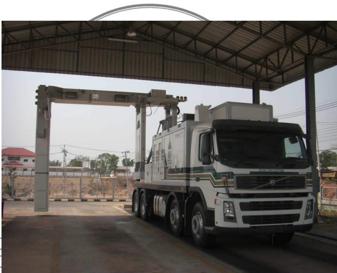
ภาพที่ 7 เครื่องเอกซเรย์ตู้คอนเทนเนอร์ THSCAN รุ่น MT 1213LT
