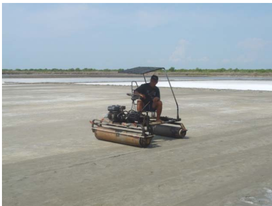
ภาพที่ 22 การกลิ้งนาโดยใช้เครื่องกลิ้งนา
