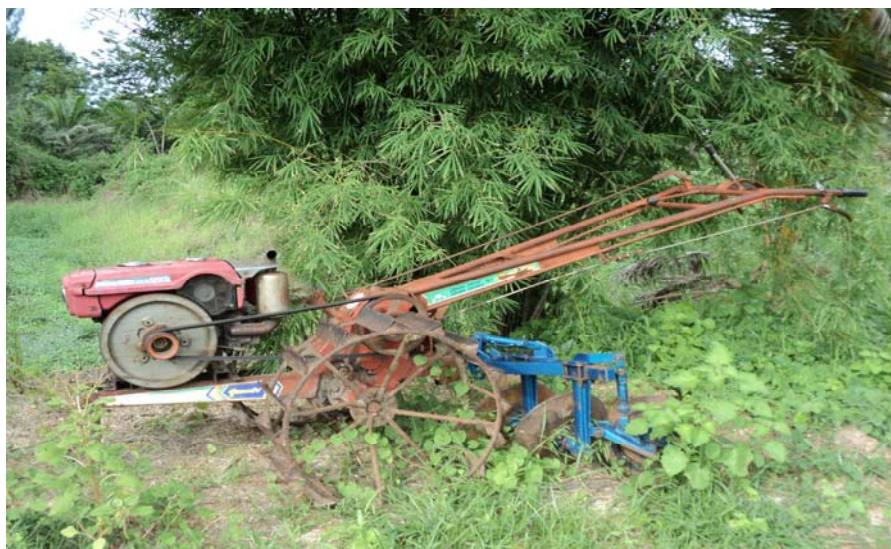
ภาพที่ 2 รถไถเดินตาม ไถเตรียมดินก่อนปลูกอ้อยสำหรับไร้อ้อยขนาดเล็ก
