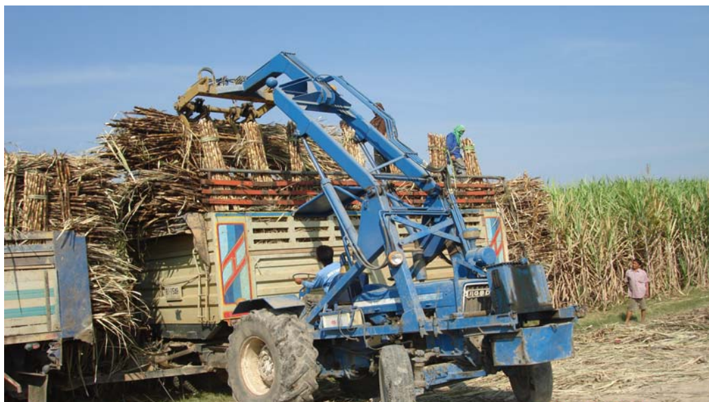
ภาพที่ 6 ชาวไร่อ้อยใช้เครื่องคีมอ้อยขึ้นรถแทนการใช้แรงงานคน
