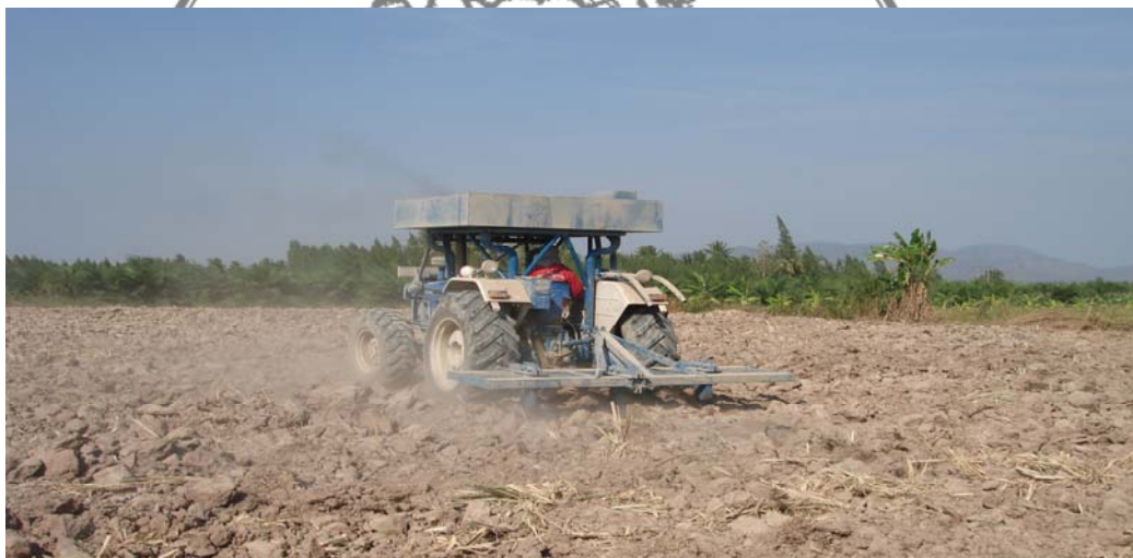
ภาพที่ 4 รถไถติดถังกักเก็บน้ำ เพื่อหยดน้ำลงในร่องปลุกอ้อยพร้อมกับพันธุ์อ้อยและปุ๋ยรองกัน
